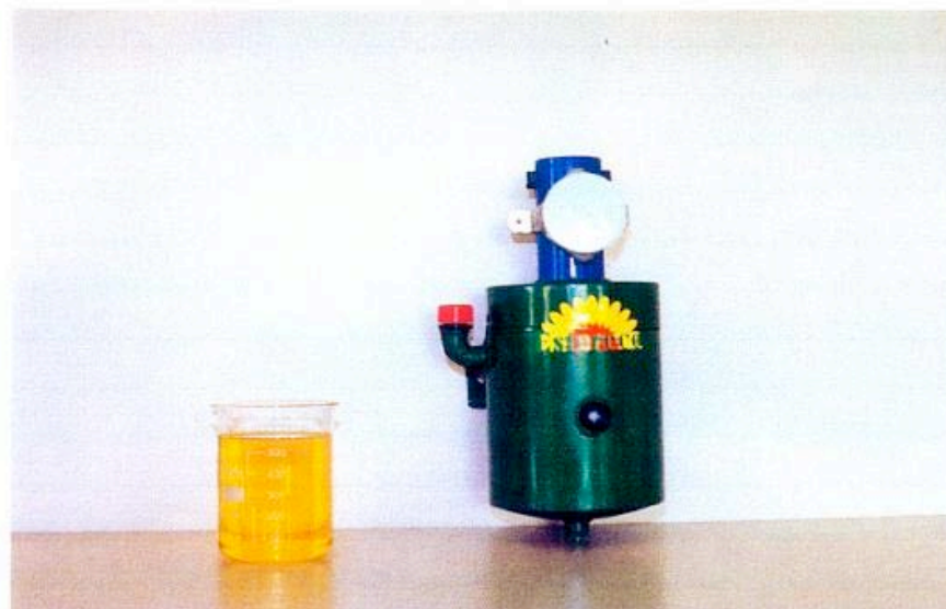
Dispositivo di protezione degli organi lubrificati per alimentazione con biodiesel
